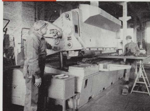
La nouvelle presse-cisaille-pliage à faible rayon d'extrémités de tôles.
