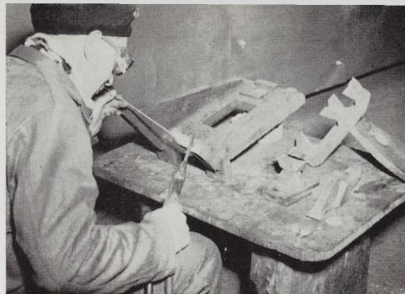
Alphonse DECONNINCK répare par recharge au chalumeau des couteaux de scraper-rabot. L'adresse du soudeur permet d'utiliser les pièces sans usinage.
