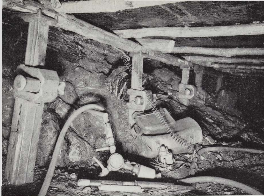
Photo N° 1 : Matériel de minage rassemblé devant le fourneau de mine.
