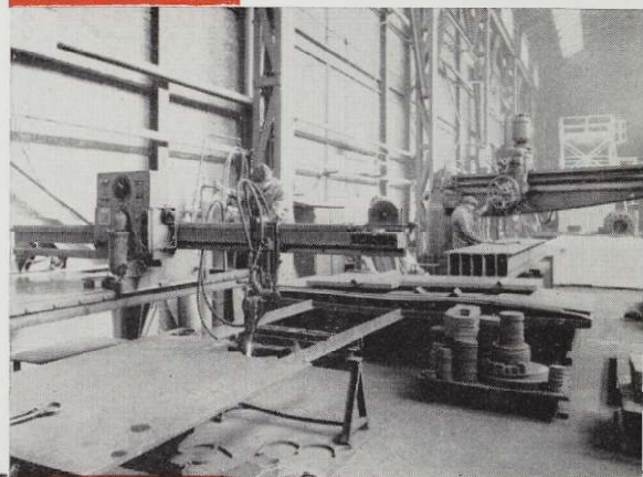
La machine «NOVAREX» découpe au chalumeau, suivant gabarit des tôles jusque 120 mm d'épaisseur.
