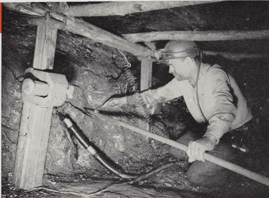
Photo N° 2 Les fronts avant minage (le boutefeu charge la mine).
