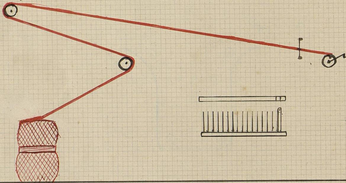
Par exemple si la chaîne comprend 100 portées et qu'elle doivent avoir 50<sup>cm</sup> de largeur, on choisira un vautoir de 2 broches au centimètre. L'ouvrier fait ensuite une petite baguette en fer ou en bois dans l'envergure et enchâsse cette baguette dans une rainure du rouleau lequel est installé de suite après le vautoir et repose par ses tourillons sur deux supports.
